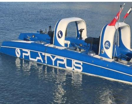
**Une plateforme de travail sous-marin multifonctions.** Le Platypus permet de disposer d'une plateforme de travail professionnel et facilite la réalisation de travaux dans les fonds sous-marins de faible profondeur: surveillance et maintenance d'installations sous-marines énergétiques (hydroliennes....), industrielles ou aquacoles (huitres, moules, etc.)
