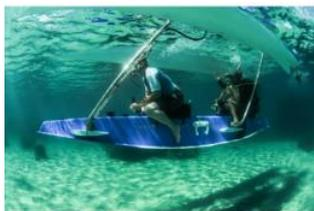
Le Platypus permet une immersion à 1,5 mètre de profondeur, sans bouteilles nécessaires
