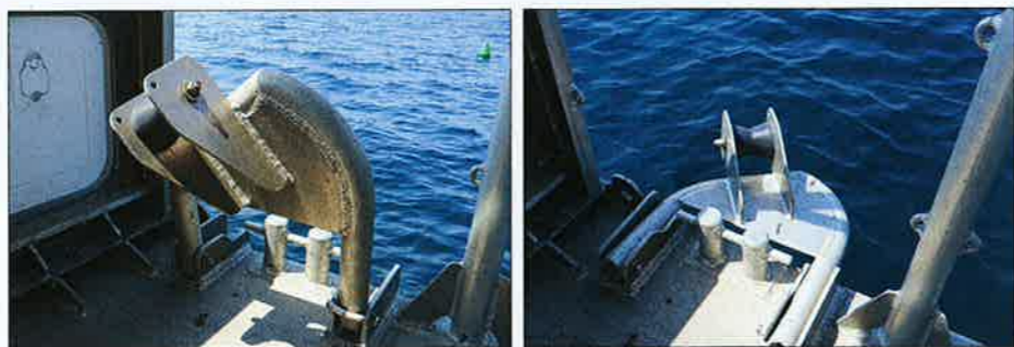
Le chantier a opté pour un système de davier basculant qui peut se relever et éviter de déborder à l'extérieur. Un taquet à poste vient compléter cet ensemble dédié au mouillage.
