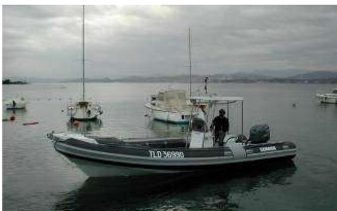
**Le Baruna**, semi rigide Lomac de 7,5 m avec un moteur Yamaha 225 cv, entièrement équipé pour la plongée.
